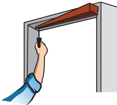
6. Проверьте, чтобы верх закрывающих каналов соприкасался с направляющей и был установлен строго вертикально. После этого просверлите отверстия под винты и прикрепите винтами закрывающие каналы к дверной коробке.
