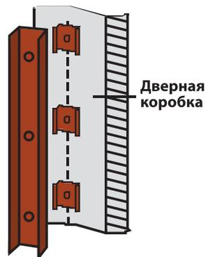
7. Закройте дверь в закрывающий канал и отметьте то место, в котором находится магнитный замок ведущей панели двери. Просверлите отверстия, прикрепите ответную часть замка.
