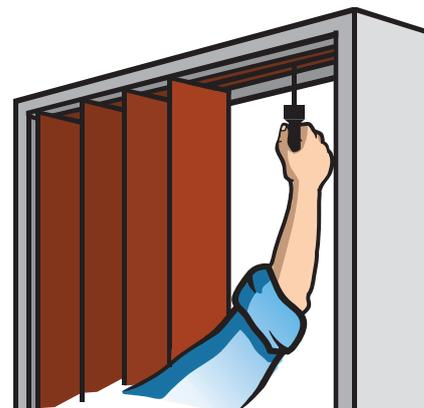
3. Замерьте расстояние от пола до направляющей. В случае, если необходимо изменить размер двери, то удалите крепежные винты с низа двери, после этого отпилите необходимый размер, затем поставьте заново крепежные винты. Дверь может быть сделана уже, путем удаления панелей и петли – для этого выньте болты вверху и внизу панели и отсоедините панель.
